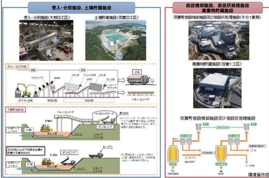
受入・分別施設では、福島県内各地にある仮置場等から中間貯蔵施設に搬入される除去土壌等を受け入れ、搬入車両からの荷下ろし、容器の破袋、可燃物・不燃物等の分別作業を行います。土壌貯蔵施設では、受入・分別施設で分別された除去土壌を放射能濃度やその他の特性に応じて安全に貯蔵します。また、廃棄物関連施設として、仮設焼却施設、仮設灰処理施設、廃棄物貯蔵施設を整備しています。仮設焼却施設では、除染廃棄物、災害廃棄物、草木などの可燃物を焼却し、減容化します。発生した焼却灰等は、さらに減容化をするために、仮設灰処理施設で溶融処理します。仮設灰処理施設で発生した灰は、鋼製の角形容器に封入して、鉄筋コンクリート造等の廃棄物貯蔵施設に貯蔵します。
