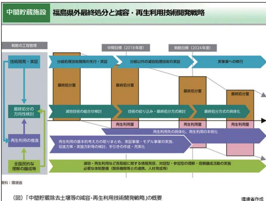
中間貯蔵開始（2015年3月）後、30年以内の福島県外最終処分に向けては、除去土壌及び焼却灰を対象として、土壌を細粒分と砂・レキに分離する分級処理や熱処理等の減容技術の活用により除去土壌等を処理し、再生利用の対象となる土壌等の量を可能な限り増やし、最終処分量の低減を図ることが重要です。除去土壌等の減容・再生利用に向けては、2016年4月に公表した『中間貯蔵除去土壌等の減容・再生利用技術開発戦略』に沿って、除去土壌等の処理技術の開発、再生利用の推進、最終処分の方向性の検討などの取組を着実に進めています。さらに、技術開発戦略の中間年度（2018年度）においては、中間目標の達成状況、それ以降の技術開発や再生利用の見直し等を総合的にレビューし、本戦略の見直しを行いました（2019年3月）。また、再生資材を公共事業等で安全に取り扱う上での技術的な留意事項を整理した手引き（案）を示し（2019年3月）、当該手引き（案）の更新も行いました（2019年12月）。
