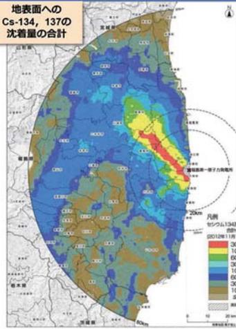
この図は、航空機モニタリングの測定結果を基に、福島県と近県における土壌表層中の放射性セシウムの沈着状況を示したマップです。
