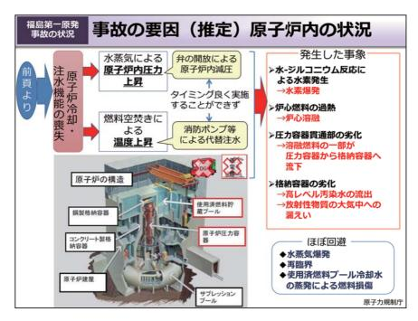
炉心への注水が停止したことによって原子炉水位が低下し、燃料が露出しました。 その結果、炉心燃料が過熱し炉心溶融が始まり、圧力容器の一部が損傷したと考えられます。溶融した燃料は圧力容器から格納容器内に漏れ出すと共に、燃料体から放出されたセシウムなどの放射性物質が格納容器内に漏えいしました。また、炉心損傷に伴う高温下において、燃料被覆管の金属(ジルコニウム)と水蒸気が反応して発生した水素が、蒸気と共に圧力容器の損傷部から格納容器内に漏えいしました。
