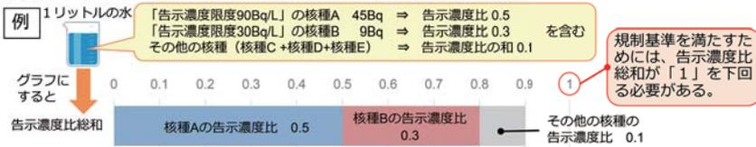
（参考）多核種除去設備等による再浄化の性能試験の結果（告示濃度比総和と主な核種の告示濃度比）
