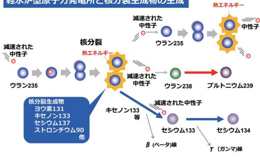
軽水炉型原子力発電所（東京電力福島第一原子力発電所も含む）は現在、世界で最も広く使われているタイプの原子炉です。燃料の濃縮ウラン（ウラン235：3～5%、ウラン238：95～97%）に中性子を当てるとき、核分裂が起こります。そのとき、ヨウ素131、セシウム137、ストロンチウム90等の放射性の核分裂生成物が作られます。また、ウラン238に中性子が当たると、プルトニウム239が作られます。
