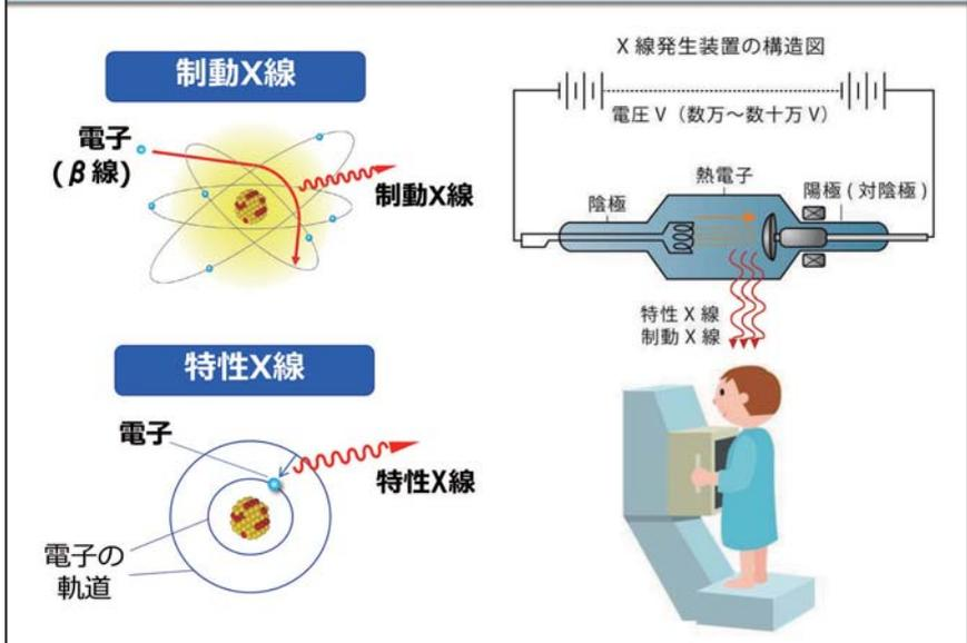
X（エックス）線検査の際には、X線管で発生させるX線が利用されます。X線管の内部では、陰極と陽極（タンガステン、モリブデン、銅等）の間に高電圧がかけられており、熱電子が真空中を陰極から陽極に高速で移動します。熱電子が陽極の原子核に引き寄せられて進行方向を変えるときに発生するX線を制動X線といいます。また、陽極の原子の内側の電子軌道の電子を弾き飛ばすと、この空いた電子軌道へ外側の電子軌道から電子が移動（遷移）します。これに伴い発生するX線を特性X線といいます。X線管で発生するX線のほとんどは制動X線です。
