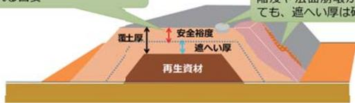
覆土厚は、土木構造物としての通常の補修がなされる場合でも、被ばくを制限するための遮へい厚が確保されるよう設計。
