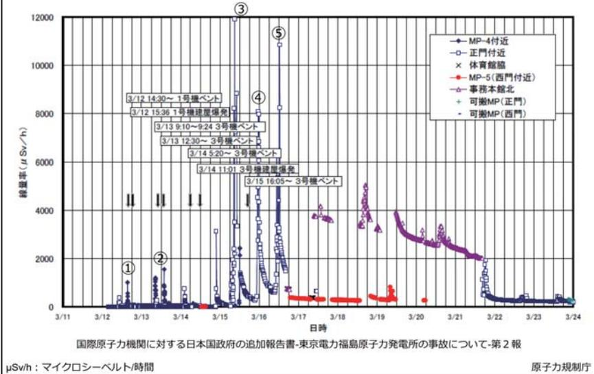
今回の事故では、事象の進展に伴い、燃料が溶融、放射性物質が压力容器から炉外に放出されました。格納容器ベント操作やさらに格納容器、原子炉建屋の損傷によって、放射性物質が炉心から空気中へ放出されることになりました。1号機のベント操作は、3月12日14時30分に格納容器の圧力が低下し、ベントが成功したと判断されています。その際、大気中に放出された放射性物質のプルームの影響で約1ミリシーベルト/時が観測されています(図中①)。翌13日にも明らかに空間線量率が上昇しました(図中②)が、これは3号機で原子炉水位が低下して、燃料が露出した後にベント操作をした影響と考えられています。3月15日9時には約12ミリシーベルト/時の数値が観測されました(図中③)が、同日早朝の6時頃に2号機で爆発音と共に圧力抑制室の圧力が低下していることから、この上昇の原因は2号機からの放射性物質の放出と考えられています。
