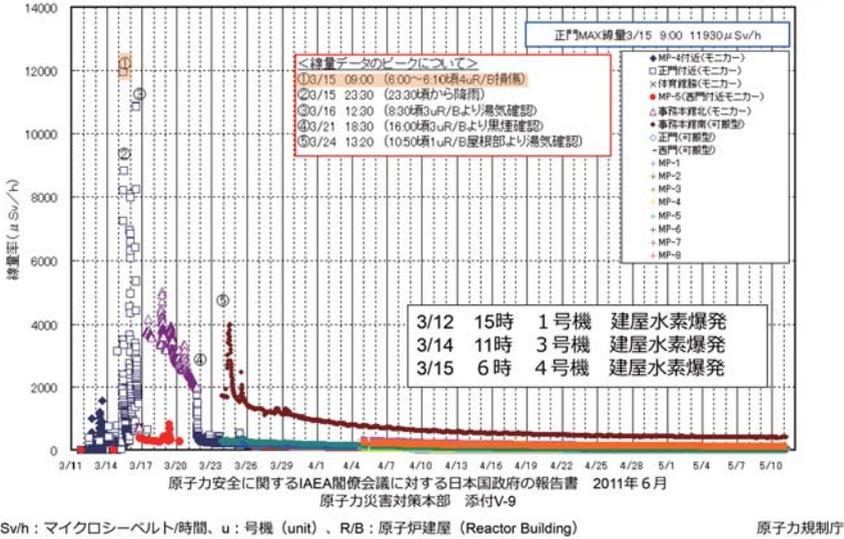
2011年3月12日の明け方に東京電力福島第一原子力発電所敷地内のモニタリングカーによる測定で空間線量率が上昇したことが判明し、地震後初めて、放射性物質の放出が明らかになりました。このとき、1号機では格納容器圧力が異常上昇した後、若干の圧力低下がみられたことから、格納容器からの放射性物質の漏れがあり、大気中の放出があったものと推定されています。その後もベント操作や建屋爆発の影響により、空間線量率の一時的上昇が何度も観察されています。最も高い空間線量率が計測されたのは3月15日9時で、発電所正門付近のモニタリングカーが約12ミリシーベルト / 時の数値を測定しています。
