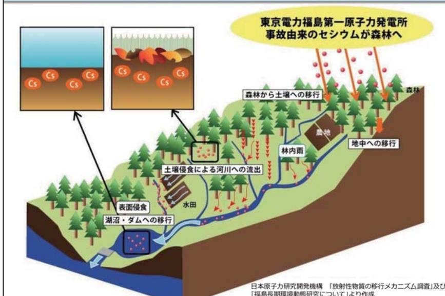
東京電力福島第一原子力発電所事故によって環境中へ放出されたセシウムの分布は時間経過と共に大きく変化しました。事故直後に樹皮や枝葉に付着したセシウムは落葉や降雨等によって林床へと移行し、現在では90%以上が地表から5cmの深さまでにとどまっていることが分かっています。一方で、地表面付近のセシウム減少量が物理減衰による減少よりも大きいことから、僅かに地中方向に移動していることが推測されています。
