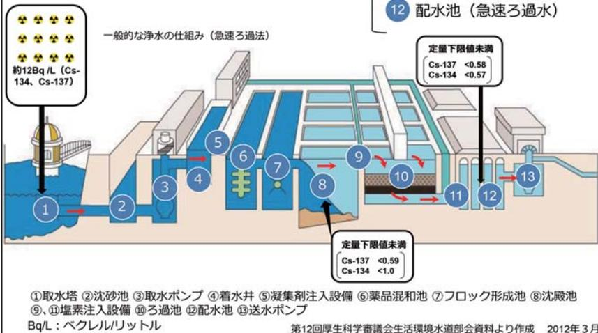
この図では、日本で一般的に用いられている浄水方法である「急速ろ過法」を示しています。急速ろ過法では、河川やダムから取り入れた水に泥や小さな粒子を沈殿させる薬剤を用いて、フロックと呼ばれる大きな塊にします。そして、上澄みの水をろ過することで水道水が作られます。
