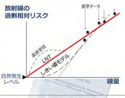
→国際放射線防護委員会（ICRP）は、放射線防護の目的上、単純かつ合理的な仮定として、直線しきい値なし（LNT）モデルを採用
