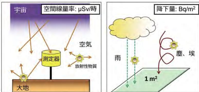
空間線量率というのは、空間中の $\gamma$ （ガンマ）線量を測定したもので、1時間当たりのマイクロシーベルトで表示されています。空気中に漂っている放射性物質からの $\gamma$ 線も検出していますし、大地に落ちた放射性物質からの $\gamma$ 線も検出しています。また計測しているのは事故由来の放射線だけではありません。自然放射線としては、主に大地からの放射線と宇宙線が挙げられます。
