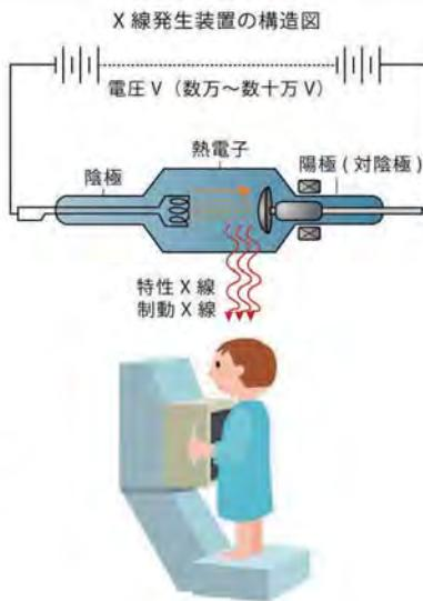
X（エックス）線検査の際には、X線管で発生させるX線が利用されます。X線管の内部では、陰極と陽極（タンクスチン、モリブデン、銅等）の間に高電圧がかけられており、熱電子が真空中を陰極から陽極に高速で移動します。熱電子が陽極の原子核に引き寄せられて進行方向を変えるときに発生するX線を制動X線といいます。また、陽極の原子の内側の電子軌道の電子を弾き飛ばすと、この空いた電子軌道へ外側の電子軌道から電子が移動（遷移）します。これに伴い発生するX線を特性X線といいます。X線管で発生するX線のほとんどは制動X線です。
