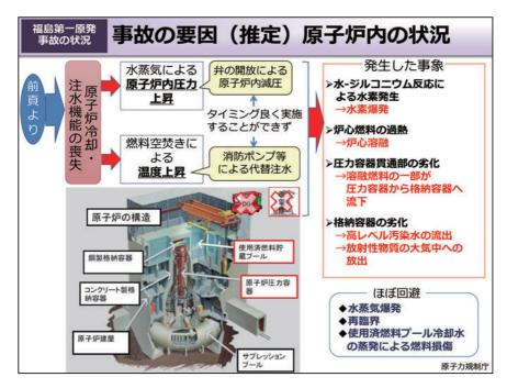
炉心への注水が停止したことによって原子炉水位が低下し、燃料が露出しました。その結果、炉心燃料が過熱し炉心溶融が始まり、圧力容器の一部が損傷したと考えられます。溶融した燃料は圧力容器から格納容器内に漏れ出すと共に、燃料体から放出されたセシウムなどの放射性物質が大量に格納容器内に放出されました。また、炉心損傷に伴う高温下において、燃料被覆管の金属(ジルコニウム)と水蒸気が反応して大量に発生した水素が、蒸気と共に圧力容器の損傷部から格納容器内に放出されました。
