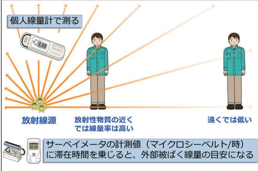
外部被ばくによる線量を計測する方法として、個人線量計を装着する方法があります。個人線量計では、一定時間に受けた放射線の積算量の計測や、線量率の読み取りが可能です。
