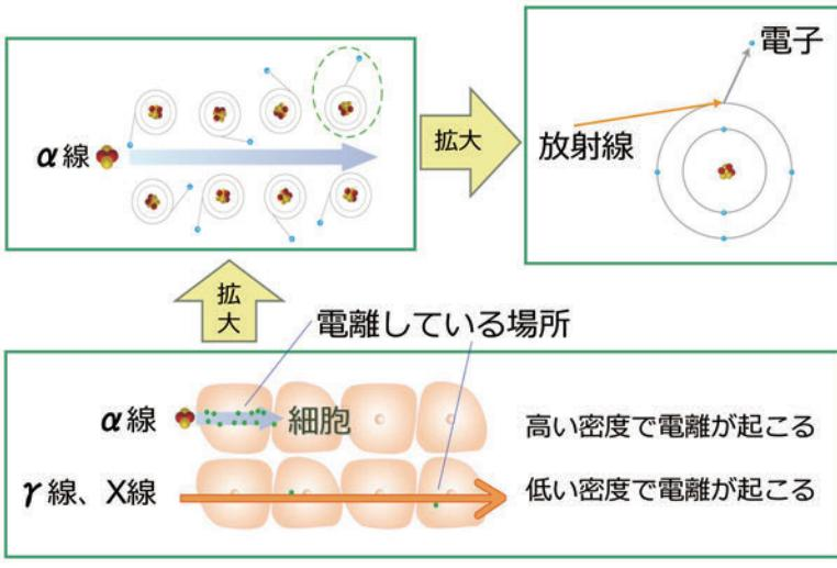
放射線はその通り道の物質にエネルギーを与えていきます。与えられたエネルギーにより、通り道の物質の電子が弾き飛ばされます。これが電離作用です。
