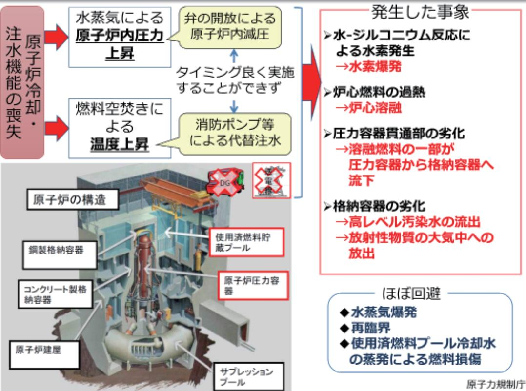
炉心への注水が停止したことによって原子炉水位が低下し、燃料が露出しました。その結果、炉心燃料が過熱し炉心溶融が始まり、圧力容器の一部が損傷したと考えられます。溶融した燃料は圧力容器から格納容器内に漏れ出すと共に、燃料体から放出されたセシウムなどの放射性物質が大量に格納容器内に放出されました。また、炉心損傷に伴う高温下において、燃料被覆管の金属（ジルコニウム）と水蒸気が反応して大量に発生した水素が、蒸気と共に圧力容器の損傷部から格納容器内に放出されました。
