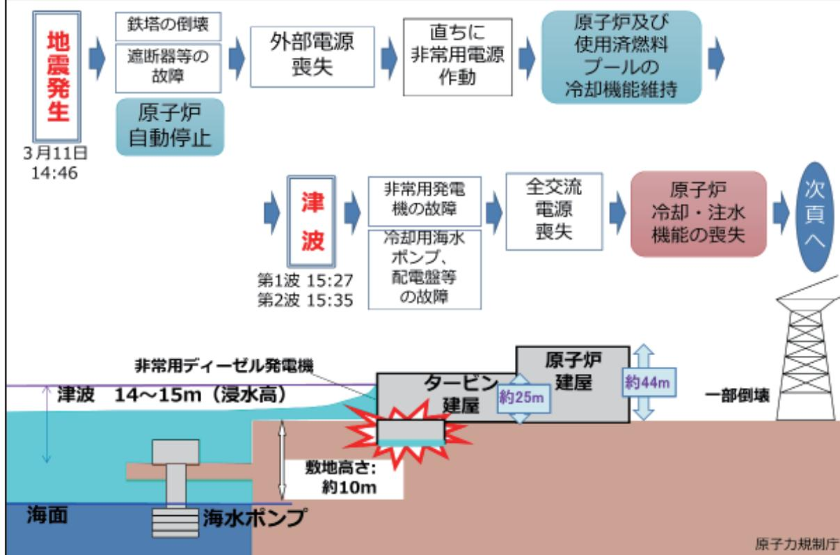
地震発生直後、運転中であった東京電力福島第一原子力発電所の1～3号機は、全ての原子炉が自動停止しました。
