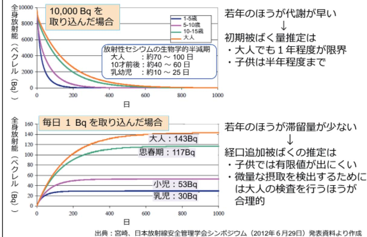
ホールボディ・カウンタでは、測定日当日の体内放射エネルギーを測ることが可能ですが、他の測定機器同様、機械の性能や測定時間によって検出限界が決まっています。
