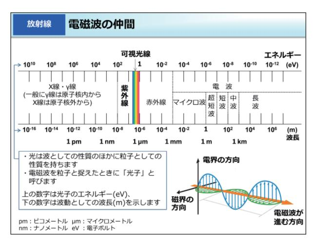
電磁波とは、電界(電場)と磁界(磁場)が相互に作用しながら空間を伝播する波のことです。波長が短くなる(周波数が高くなる)ほど、電磁波のエネルギーは高くなります。また放射線のエネルギーは電子ボルト(eV)で表されます。1eV は1.6 x 10<sup>-19</sup> ジュール(J)です。
