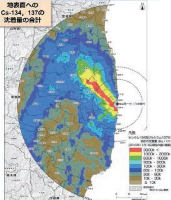
この図は、航空機モニタリングの測定結果を基に、福島県と近県における土壌表層中の放射性セシウムの沈着状況を示したマップです。
