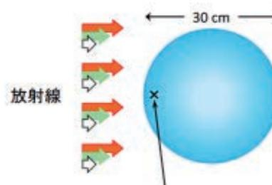
サーベイメータで測定される周辺線量当量は、直径30cmのICRU球の深さ1cmにおける線量当量で定義される。
