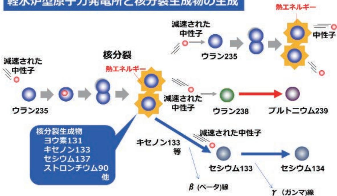
軽水炉型原子力発電所（東京電力福島第一原子力発電所も含む）は現在、世界でも広く使われているタイプの原子炉です。燃料の濃縮ウラン（ウラン235：3～5%、ウラン238：95～97%）に中性子を当てると、核分裂が起こります。そのとき、ヨウ素131、セシウム137、ストロンチウム90等の放射性的核分裂生成物が作られます。また、ウラン238に中性子が当たると、プルトニウム239が作られます。
