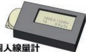
放射線は目に見えませんが、電離作用や励起作用などが知られており（上巻P45「放射線測定の原理」）、それらを利用して様々な測定機器が目的と用途に応じて作られています。上記の様々な測定機器は全て励起作用を利用しています。
