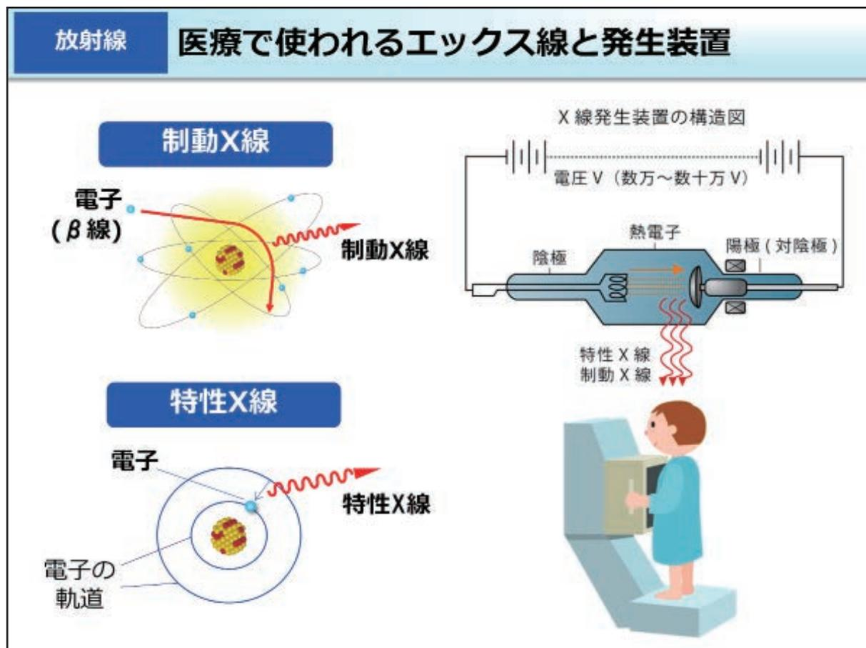
X(エックス)線検査の際には、X線管で発生させるX線が利用されます。X線管の内部では、陰極と陽極(タングステン、モリブデン、銅等)の間に高電圧がかけられており、熱電子が真空中を陰極から陽極に高速で移動します。熱電子が陽極の原子核に引き寄せられて進行方向を変えるときに発生するX線を制動X線といいます。また、陽極の原子の内側の電子軌道の電子を弾き飛ばすと、この空いた電子軌道へ外側の電子軌道から電子が移動(遷移)します。これに伴い発生するX線を特性X線といいます。X線管で発生するX線のほとんどは制動X線です。
