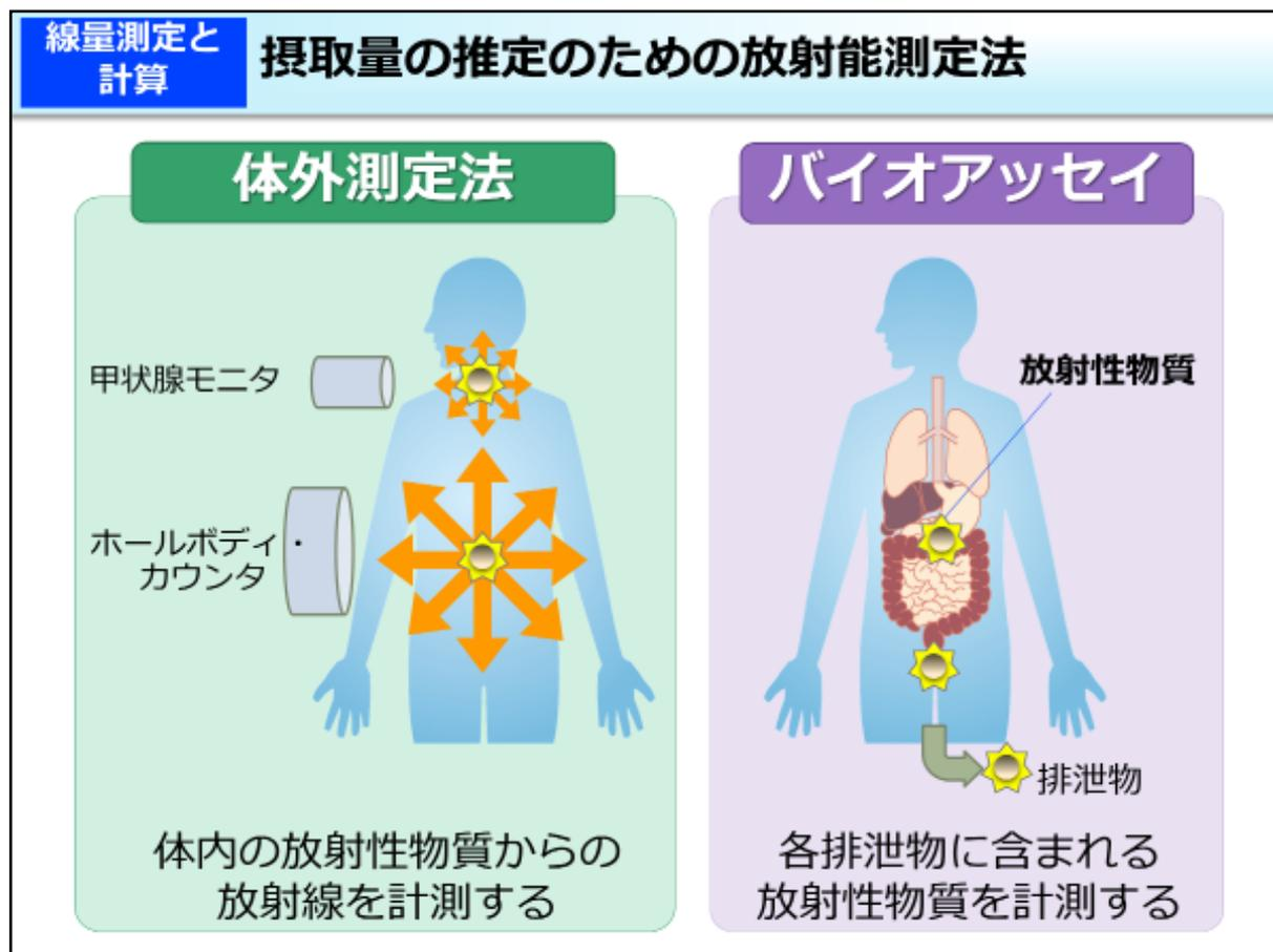
内部被ばく線量の計算に必要な摂取量の推定には、体の中から出てくる $\gamma$ (ガンマ)線を直接測る体外計測法と、尿や便の中にある放射性物質の量を測るバイオアッセイを用いる方法があります。
