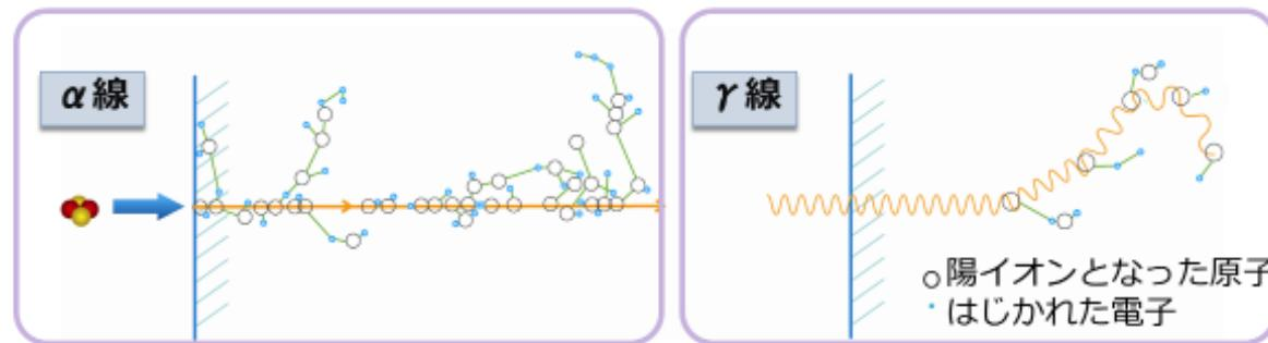
放射線が物質中を通過する場合、持っているエネルギーにより、物質を構成している原子が持つ軌道電子を弾き出して、陽電荷を帯びた状態の原子（又は陽イオンの分子）と自由な電子とに分離します。これを電離作用といいます。
