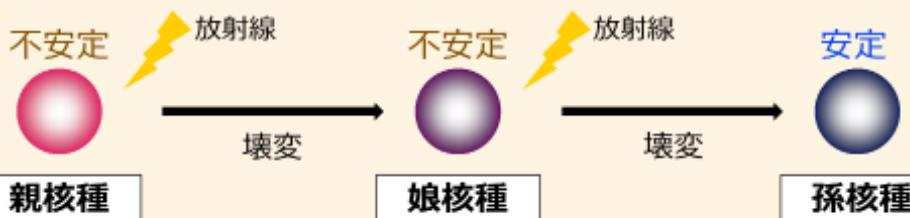
壊変前の核種を「親核種」、壊変後の核種を「娘核種」と呼びます。
