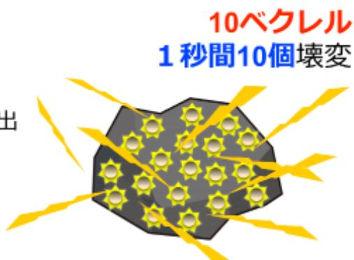
放射性物質では、原子核がエネルギー的に不安定な状態にあります。そこで、余分なエネルギーを出して、安定な状態に変わろうとします。このエネルギーを放射線として放出します。
