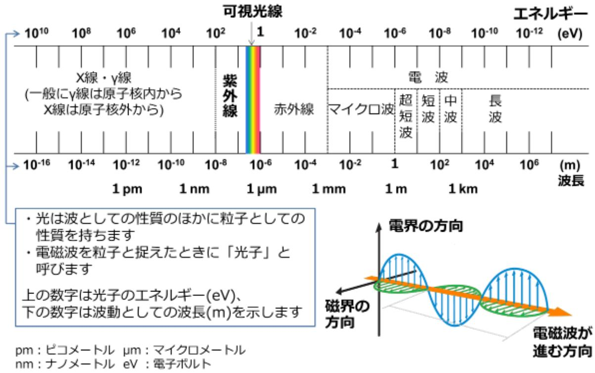
電磁波とは、電界（電場）と磁界（磁場）が相互に作用しながら空間を伝播する波のことです。波長が短くなる（周波数が高くなる）ほど、電磁波のエネルギーは高くなります。また放射線のエネルギーは電子ボルト（eV）で表されます。1 eV は  $1.6 \times 10^{-19}$  ジュール（J）です。
