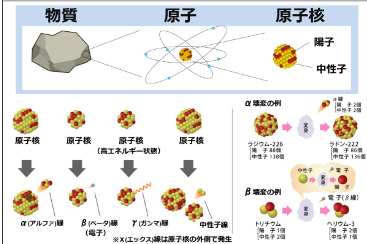
$\alpha$ (アルファ) 線、 $\beta$ (ベータ) 線、 $\gamma$ (ガンマ) 線、X(エックス) 線という名前は、これらの放射線が発見された当時、その実体が分からなかったために付けられた名称です。今では、 $\alpha$ 線とは、陽子2個と中性子2個からなるヘリウム原子核が高速で飛び出したものであることが分かっています。また $\beta$ 線は原子核から飛び出した電子です。ヘリウム原子核は、電子の約7,300倍の重さです。 $\alpha$ 線や $\beta$ 線を出した直後の原子核は、通常、まだエネルギーが高く、不安定な状態なので、 $\gamma$ 線を出して、より安定した状態になろうとします。しかし中には $\gamma$ 線を出さないものもあります。
