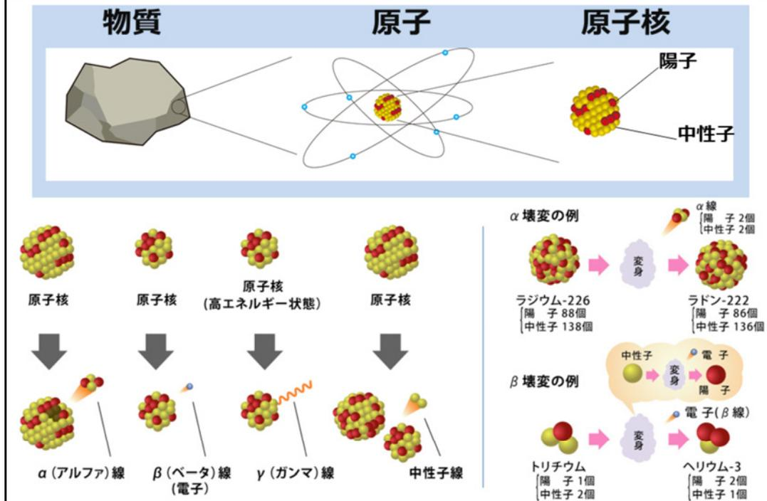
$\alpha$  (アルファ) 線、 $\beta$  (ベータ) 線、 $\gamma$  (ガンマ) 線、X (エックス) 線という名前は、これらの放射線が発見された当時、その実体が分からないために付けられた名称です。今では、 $\alpha$  線とは、陽子2個と中性子2個からなるヘリウム原子核が高速で飛び出したものであることが分かっています。また  $\beta$  線は原子核から飛び出した電子です。ヘリウム原子核は、電子の約7,300倍の重さです。 $\alpha$  線や  $\beta$  線を出した直後の原子核は、通常、まだエネルギーが高く、不安定な状態なので、 $\gamma$  線を出して、より安定した状態になろうとします。しかし中には  $\gamma$  線を出さないものもあります。
