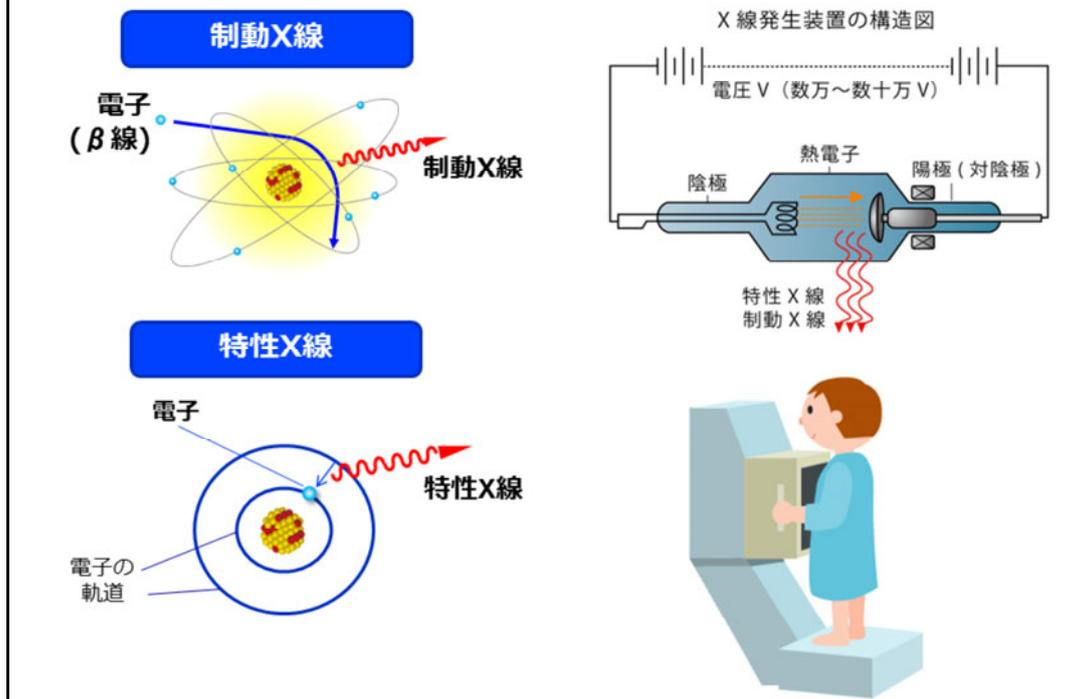
X(エックス)線検査の際には、X線管で発生させるX線が利用されます。X線管の内部では、陰極と陽極(タングステン、モリブデン、銅等)の間に高電圧がかけられており、熱電子が真空中を陰極から陽極に高速で移動します。熱電子が陽極の原子核に引き寄せられて進行方向を変えるときに発生するX線を制動X線といいます。また、陽極の原子の内側の電子軌道の電子をはじき飛ばすと、この空いた電子軌道へ外側の電子軌道から電子が移動(遷移)します。これに伴い発生するX線を特性X線といいます。X線管で発生するX線のほとんどは制動X線です。
