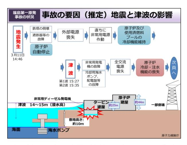
地震発生直後、運転中であった東京電力福島第一原子力発電所の1~3号機は全て の原子炉が自動停止しました。
