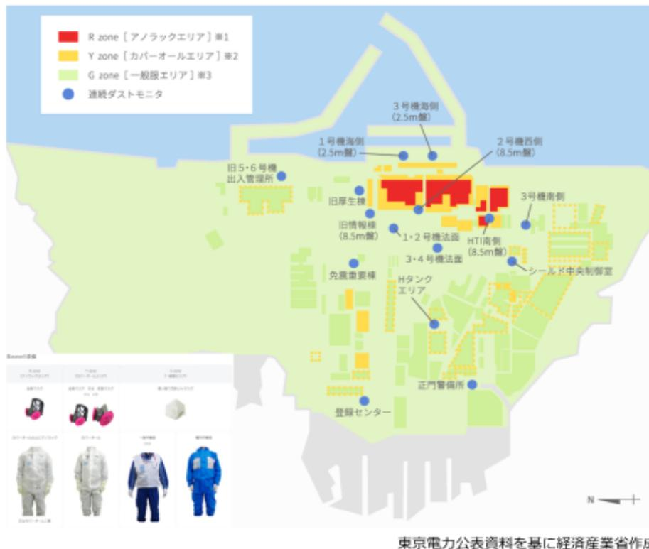
東京電力福島第一原子力発電所では、作業時の負荷軽減による安全性と作業性の向上を図るため、ガレキ撤去やフェーシング等による労働環境の改善を進めた結果、一般作業服等で作業可能なエリアが、平成30年6月に、構内面積の約96%に拡大しました。
