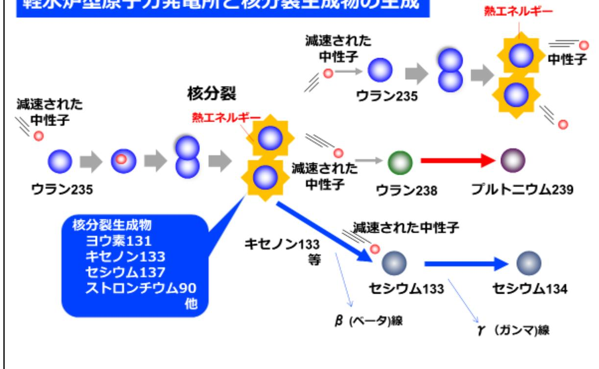
軽水炉型原子力発電所（東京電力福島第一原子力発電所も含む）は現在、世界でも広く使われているタイプの原子炉です。燃料の濃縮ウラン（ウラン235：3～5%、ウラン238：95～97%）に中性子を当てると、核分裂が起こります。そのとき、ヨウ素131、セシウム137、ストロンチウム90等の放射性的核分裂生成物が作られます。また、ウラン238に中性子が当たると、プルトニウム239が作られます。
