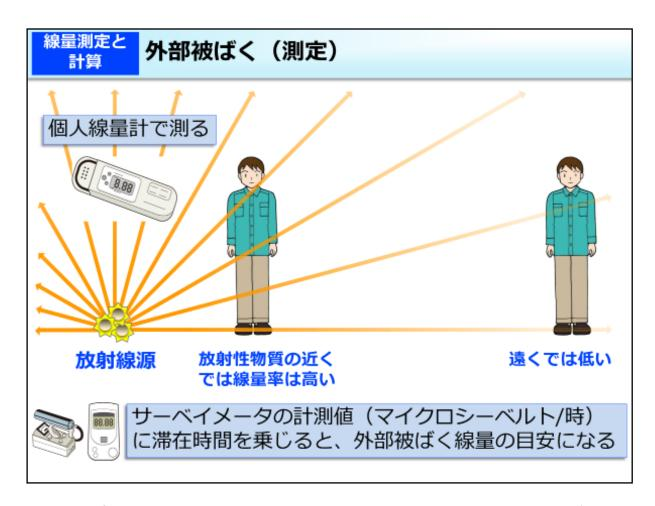
外部被ばくによる線量を計測する方法として、個人線量計を装着する方法があります。個人線量計では、一定時間に受けた放射線の積算量の計測や、線量率の読み取りが可能です。
