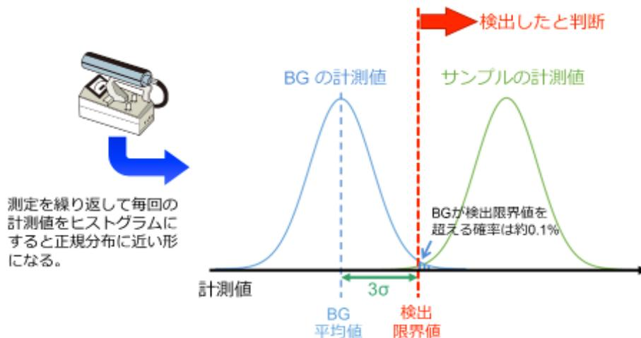
一般的にサーベイメータ等でバックグラウンドの放射能や線量率を測定する場合、測定条件のわずかな変化が計測値に影響を与えます。そのため信頼できる計測結果を得るためには、何回か繰り返し測定を行う必要があります。
