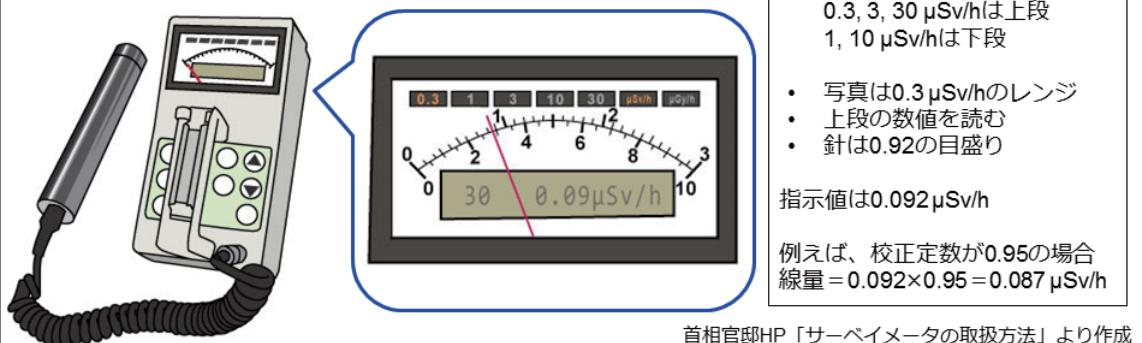
線量の測定方法の例として、NaIシンチレーション式サーベイメータを用いた $\gamma$ （ガンマ）線空間線量率の測定方法を図示しております。
