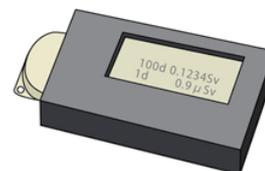
放射線は目に見えませんが、電離作用や励起作用などが知られており(上巻P44「放射線測定の原理」、それらを利用して様々な測定機器が目的と用途に応じて作られています。上記の様々な測定機器は全て励起作用を利用しています。
