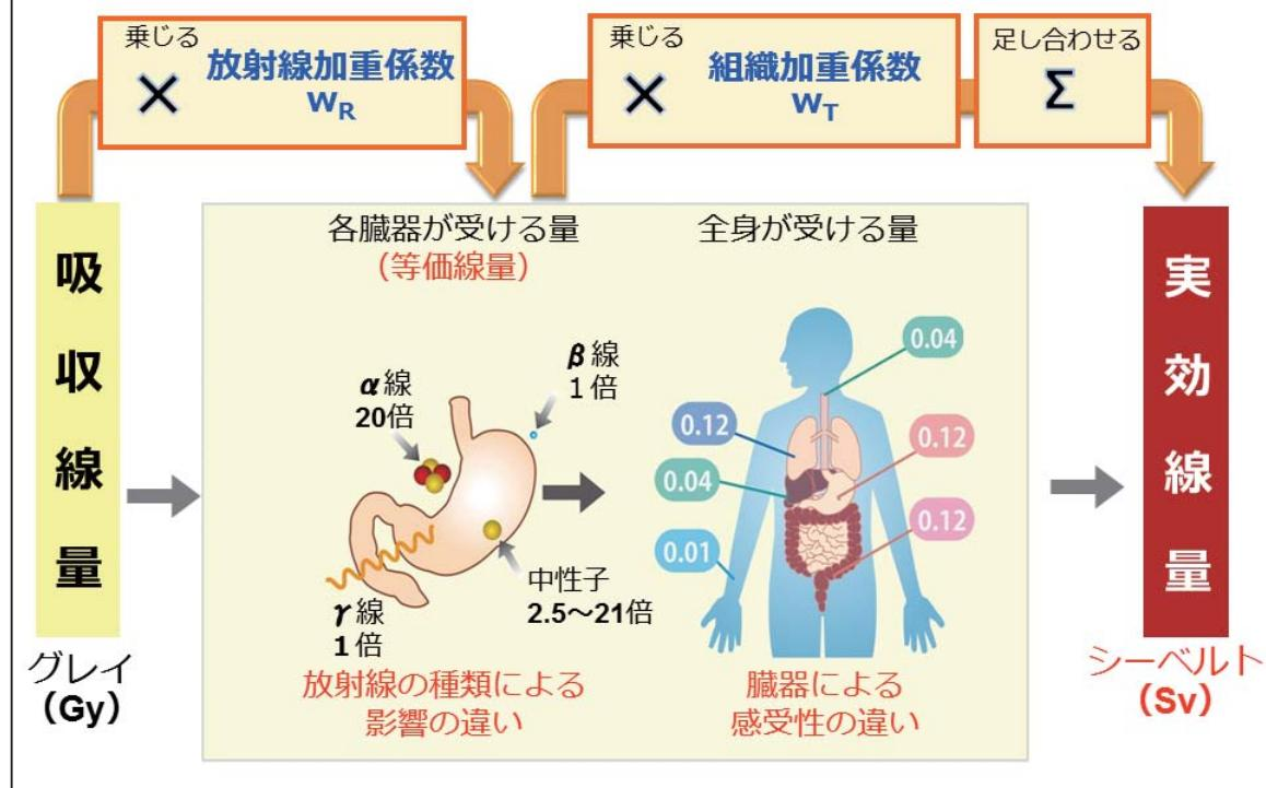
放射線被ばくによる全身影響を表す実効線量を求めるに当たっては、まず被ばくした箇所の組織・臓器ごとの吸収線量を知る必要があります。各組織と臓器の吸収線量に、放射線の種類を考慮するための放射線加重係数( $w_R$ )を乗じて、導き出されるのが等価線量(単位はシーベルト)です。放射線加重係数は人体への影響が大きい放射線ほど、大きな値になります( $\alpha$ (アルファ)線:20、 $\beta$ (ベータ)線と $\gamma$ (ガンマ)線:1)。
