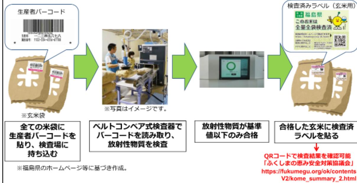
福島県では、2012年産米から、ベルトコンベア式の検査器を用い、国から指示された地域のみならず県内全域での全袋検査を、県の取組として実施しています。
