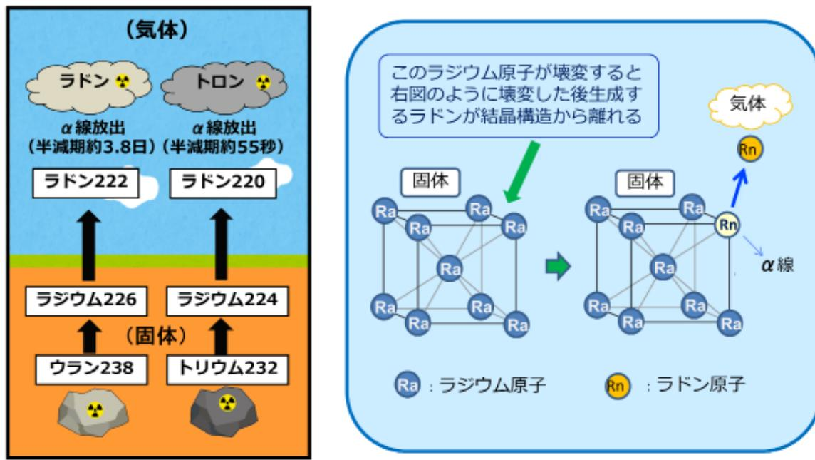
放射性物質であるラジウムは常温常圧下で右図に示すような体心立方という結晶構造で固体として存在しています。
