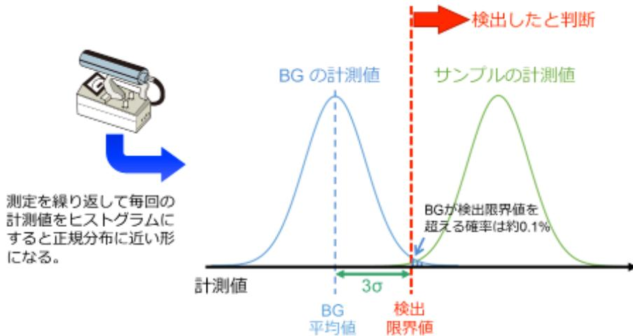
一般的にサーベイメータ等でバックグラウンドの放射能や線量率を測定する場合、測定条件のわずかな変化が計測値に影響を与えます。そのため信頼できる計測結果を得るために何回か繰り返し測定を行う必要があります。
