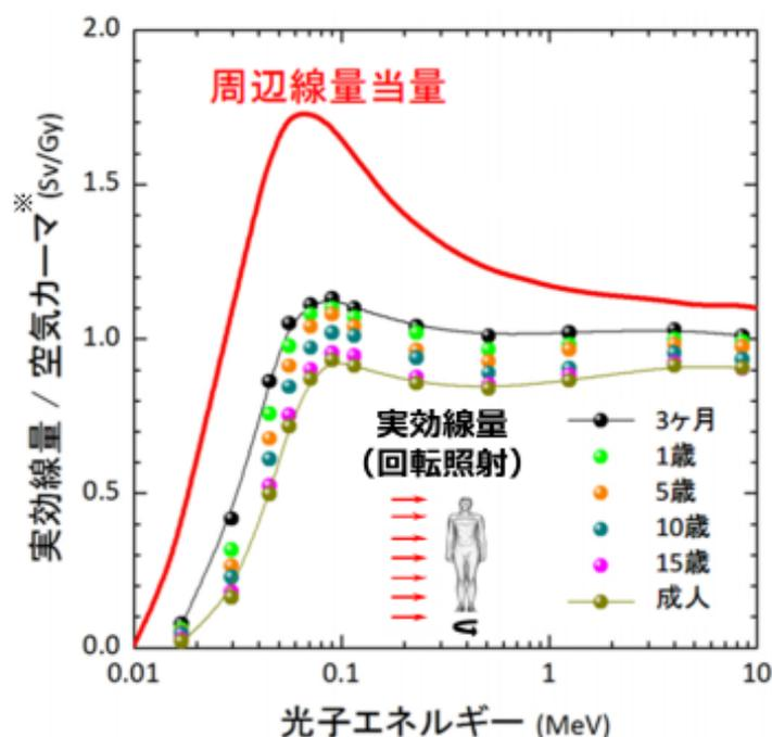
サーベイメータで測定される周辺線量当量は、直径30cmのICRU球の深さ1cmにおける線量当量で定義される。
