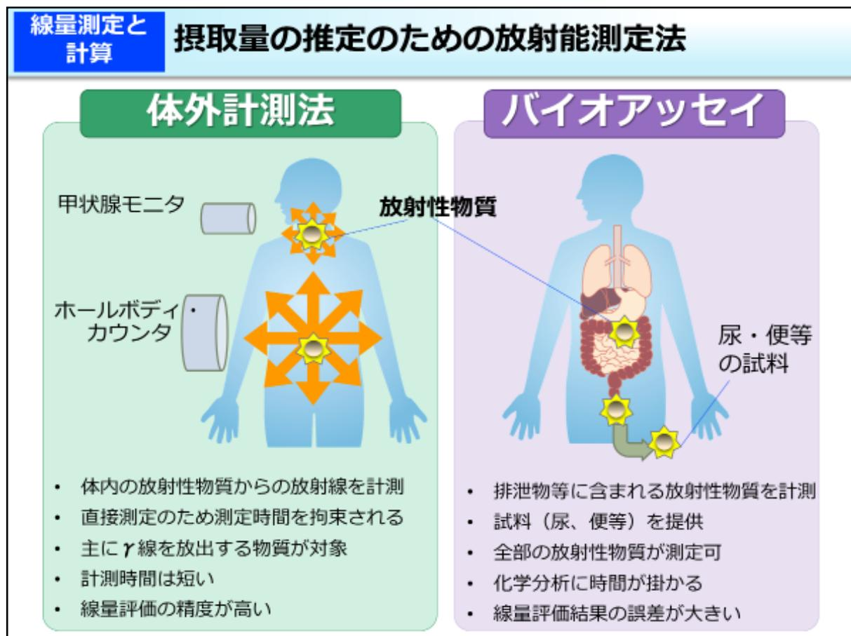
内部被ばく線量の計算に必要となる摂取量の推定には、体の中から出てくる $\gamma$ （ガンマ）線等を直接測る体外計測法と、尿や便等の試料中にある放射性物質の量を測るバイオアッセイを用いる方法があります。
