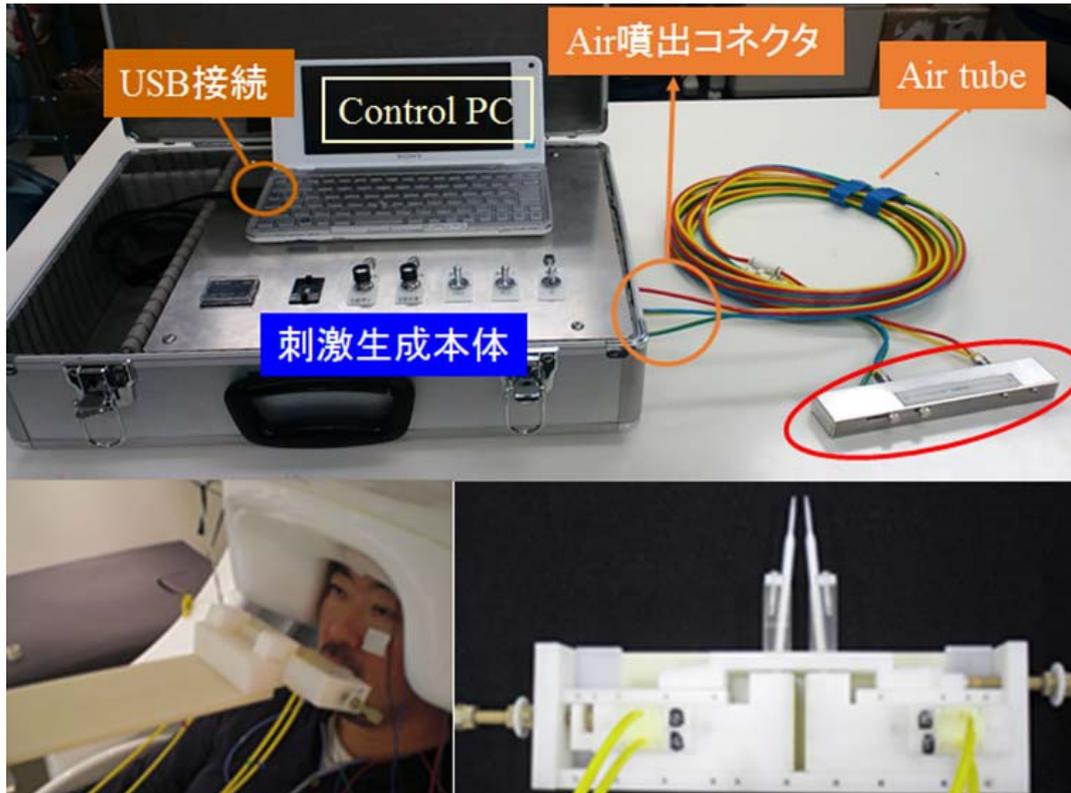
図4:脳磁図に対応した舌の二点識別覚刺激システム。刺激プローブ（右下）は空気圧で駆動し、1点/2点刺激の種類、押し出しタイミング、持続時間等をミリ秒以下の精度でPCを用いて精密に制御できる（上）。刺激プローブ部分は全てプラスチック素材を用いており、磁場ノイズを一切発生しない。刺激部はカセットで覆い、それを軽く口にくわえて舌尖や口唇を当てると、スリットから刺激プローブが突出して皮膚を刺激する（左下）。
