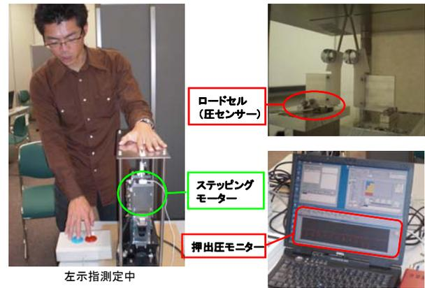
図2：二点識別覚自動検査システム
