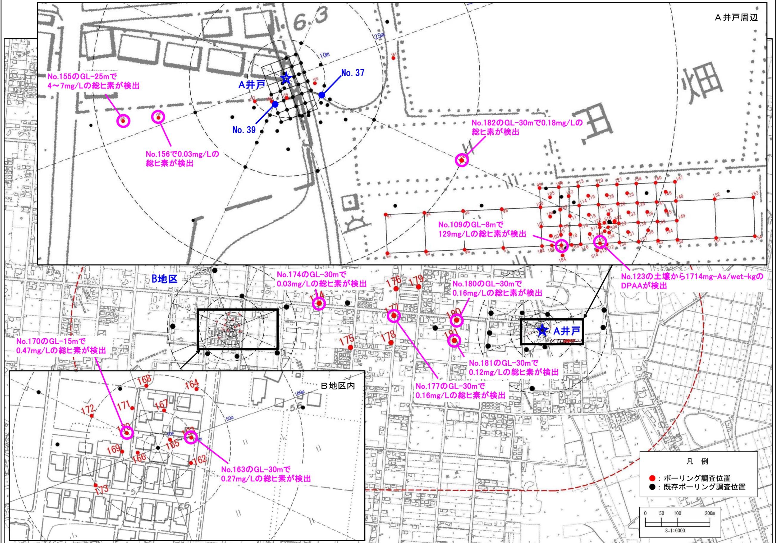
図1.2.7 汚染源掘削等調査位置図（AB間での汚染範囲把握、地下水流向、透水性把握のための追加調査
