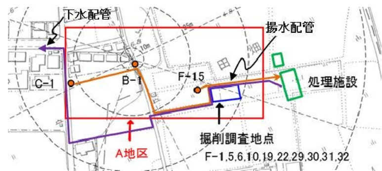
図 1.1.2 高濃度汚染対策事業における井戸、処理施設等の配置図
