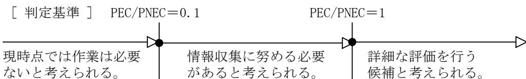
現時点では環境中濃度に関するデータが得られなかったため、生態リスクの判定はできない。しかし、一般製品中のジニトロトルエン各異性体の含有率は、2,4-ジニトロトルエンが約 75%、2,6-ジニトロトルエンが約 20% であるため、本物質の環境中濃度は両異性体の濃度よりも高くなることはないと類推された。仮に本物質の予測環境中濃度 (PEC) を両異性体の最大環境中濃度である 0.06 µg/L 程度 (2,6-ジニトロトルエン) と考えても、予測無影響濃度 (PNEC) との比は 0.04 となり、現時点では新たな作業は必要ないと考えられる。
