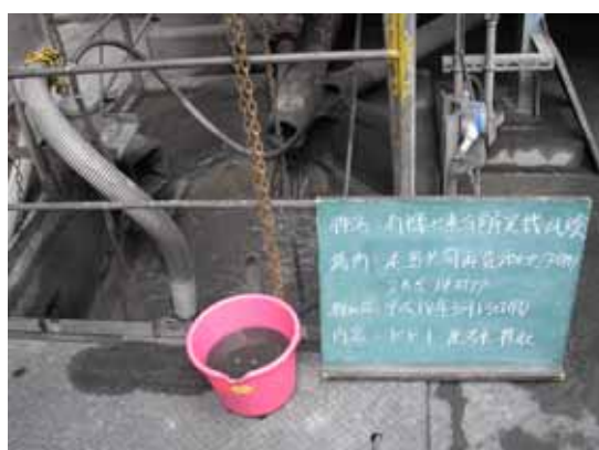
写真 3-8 灰污水採取状況
