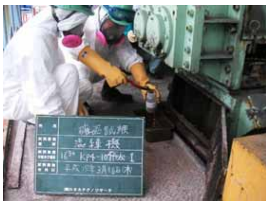
写真 3-7 飛灰(薬剤処理後)サンプリング状況
