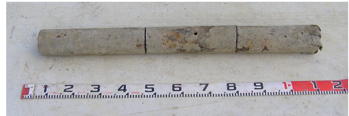
パイプ長さ約 1m を 3 分割にカットし内容物を取り出し
