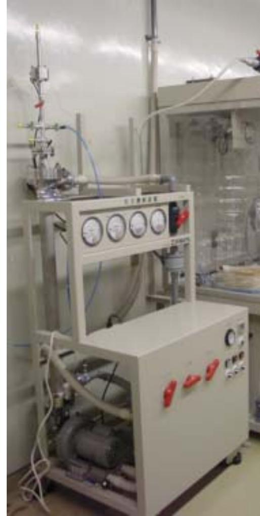
図1 . 拡散希釈を利用したガス状成分分離部
