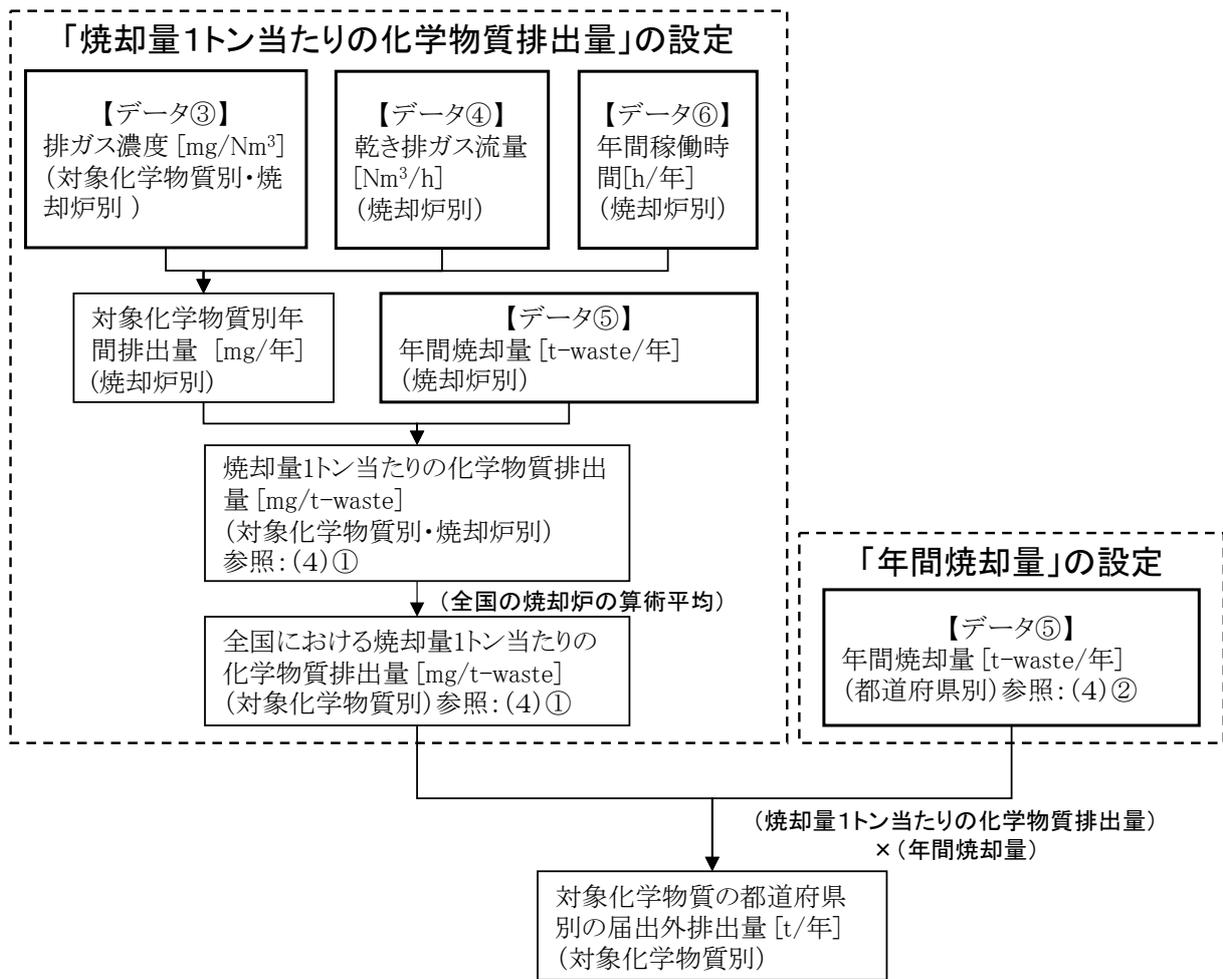
図 23-2 焼却施設に係る排出量の推計フロー
