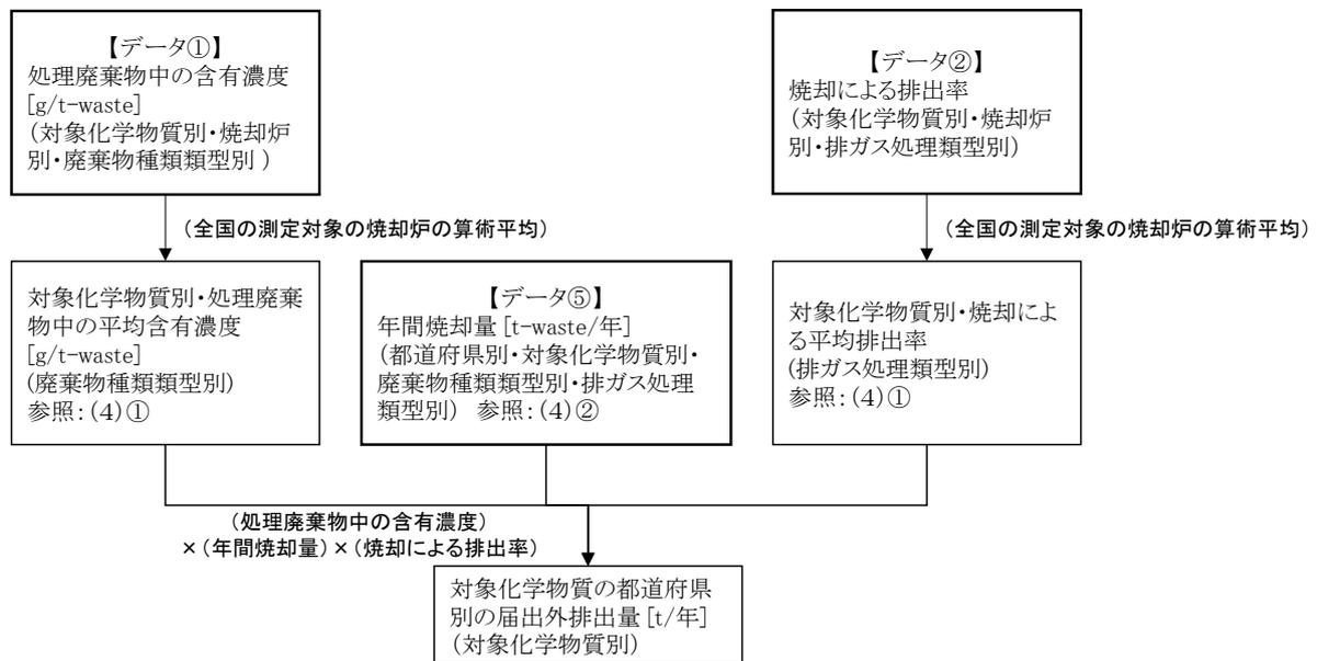
図 23-1 焼却施設に係る排出量の推計フロー
