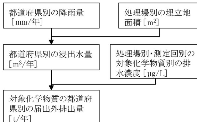
図2 最終処分場に係る排出量の推計フロー
